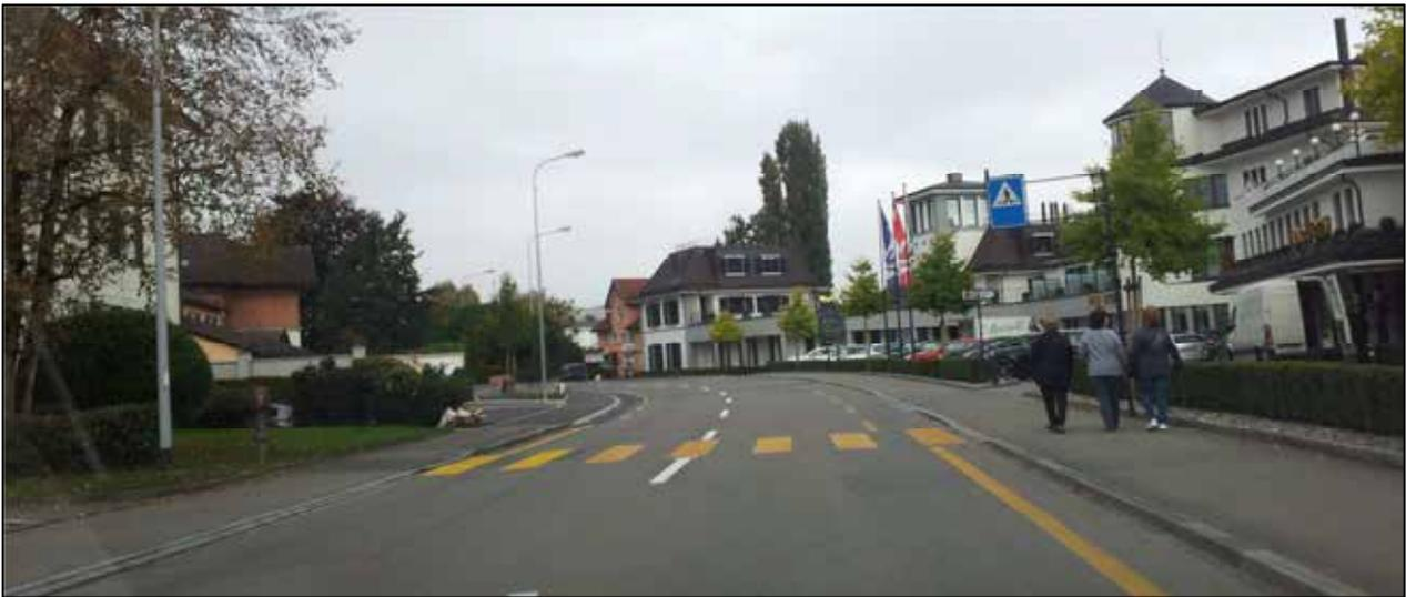
Beim Bad Horn soll die Fahrbahn aufgeweitet werden um den Fussgängerstreifen mit einer Mittelinsel ausstatten zu können. Die Velostreifen werden im Bereich des Fussgängerstreifens unterbrochen. Die Mindest-Sichtweiten von 55m auf die Warteflächen des Fussgängerstreifens können eingehalten werden.
